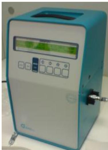
Рисунок 1 – Анализатор давления насыщенных паров MINIVAP LPG
